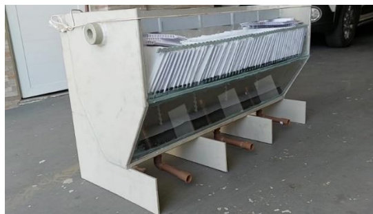
Figura 2 - Protótipo de decantador montado
