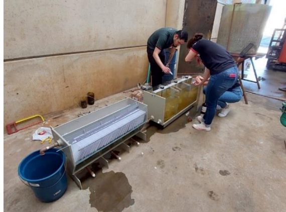
Figura 11 - Protótipo de estação de tratamento de água
