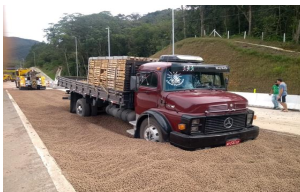
Figura 5 – Veículo de carga utilizando do dispositivo de segurança
