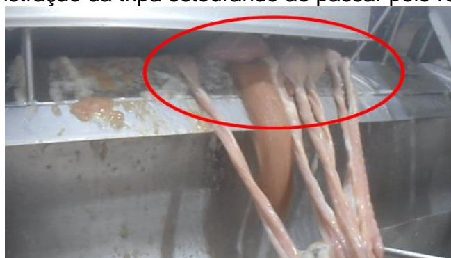
Figura 03 – Demonstração da tripa estourando ao passar pelo rolo do equipamento.
