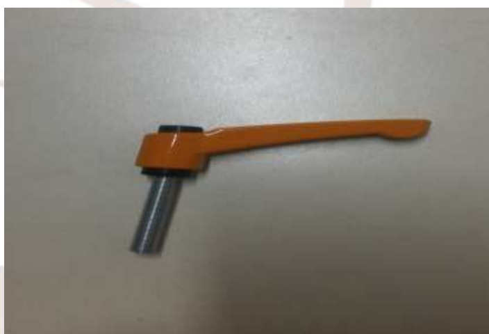
Figura 05: Alavanca de aperto em aço.
