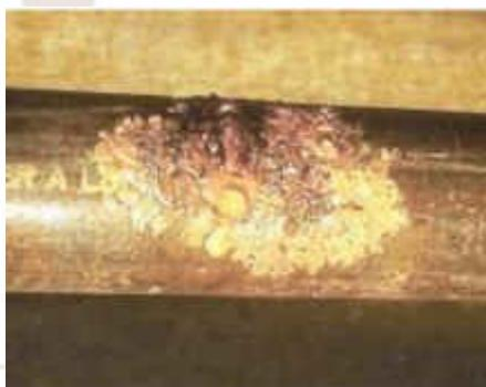
Figura 03 representando a corrosão puntiforme.
