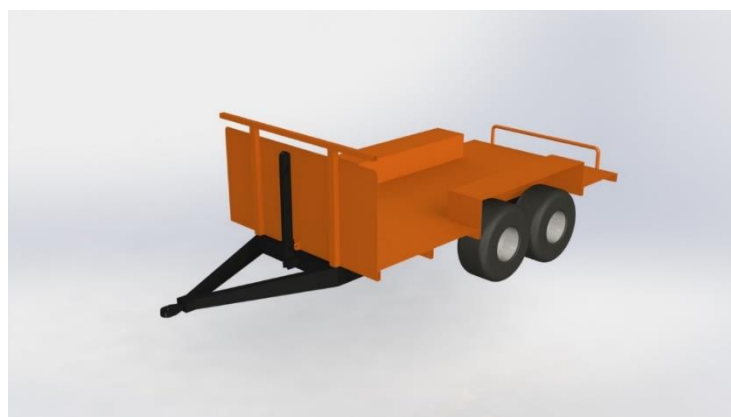
Figura 5 – Montagem final carreta de altura ajustável (Posição de altura mínima).
