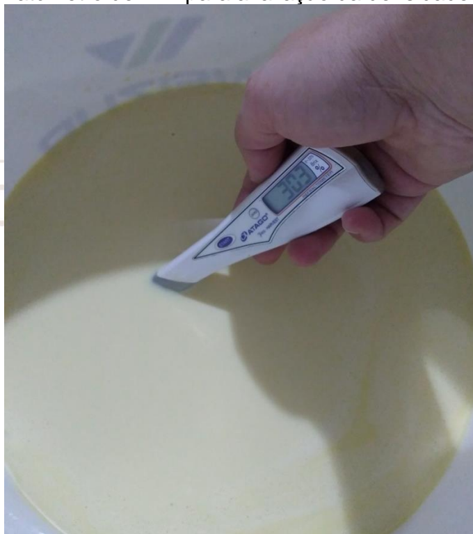
Figura 1- Refratômetro de Brix para avaliação da densidade do colostro.
